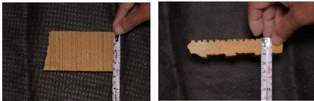
図2 スクラッチタイル (左: 正面、右: 断面)
