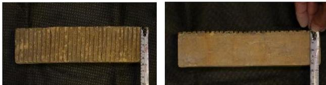
図1 スダレ煉瓦 (左: 正面、右: 断面)
